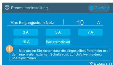
**Hinweis:** Der Netzstrom ist auf 10 A voreingestellt. Die Änderung wird erst dann wirksam, wenn die EP500Pro an das Netz angeschlossen wird.
