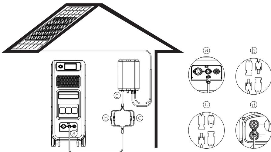
a. DC-Ausgangskabel an EP500Pro
