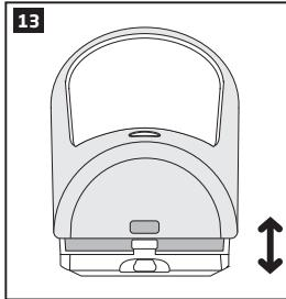
2. Вытащите пластиковую пластину, находящуюся между одним из контактов батареи и клеммой питания батареи.
