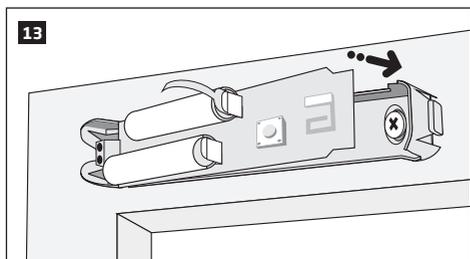
7. Откройте крышку корпуса магнита и привинтите (см. рис. 16А) или прикрепите магнит при помощи двусторонней липкой ленты (см. рис. 16В) к дверному косяку или к оконной раме и убедитесь, что магнит установлен на одном уровне с магнитным контактом EWD2.
