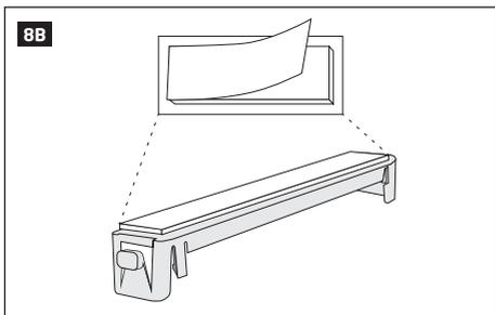
**ВНИМАНИЕ:** При использовании данного метода крепления (рис. нр. 8В), кнопка тампера в задней части корпуса НЕ будет работать.
