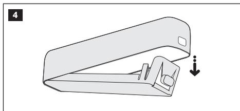
2. Выньте печатную плату (PCB) из корпуса устройства.
